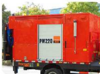
大容量双级配保温料仓，满足沥青路面上面层和中面层路病同时修复的要求
