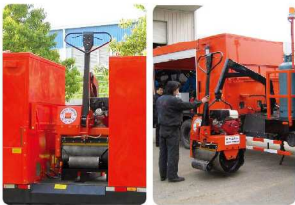
起吊装置可轻松装卸小型压路机等配件
