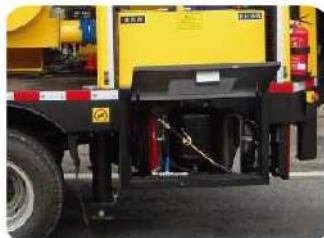
乳化沥青喷洒系统位于车身左后侧，使用更方便
