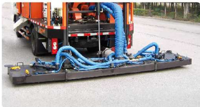
可展开式的加热墙，可一次性修复横跨一个车道的反射性裂缝
