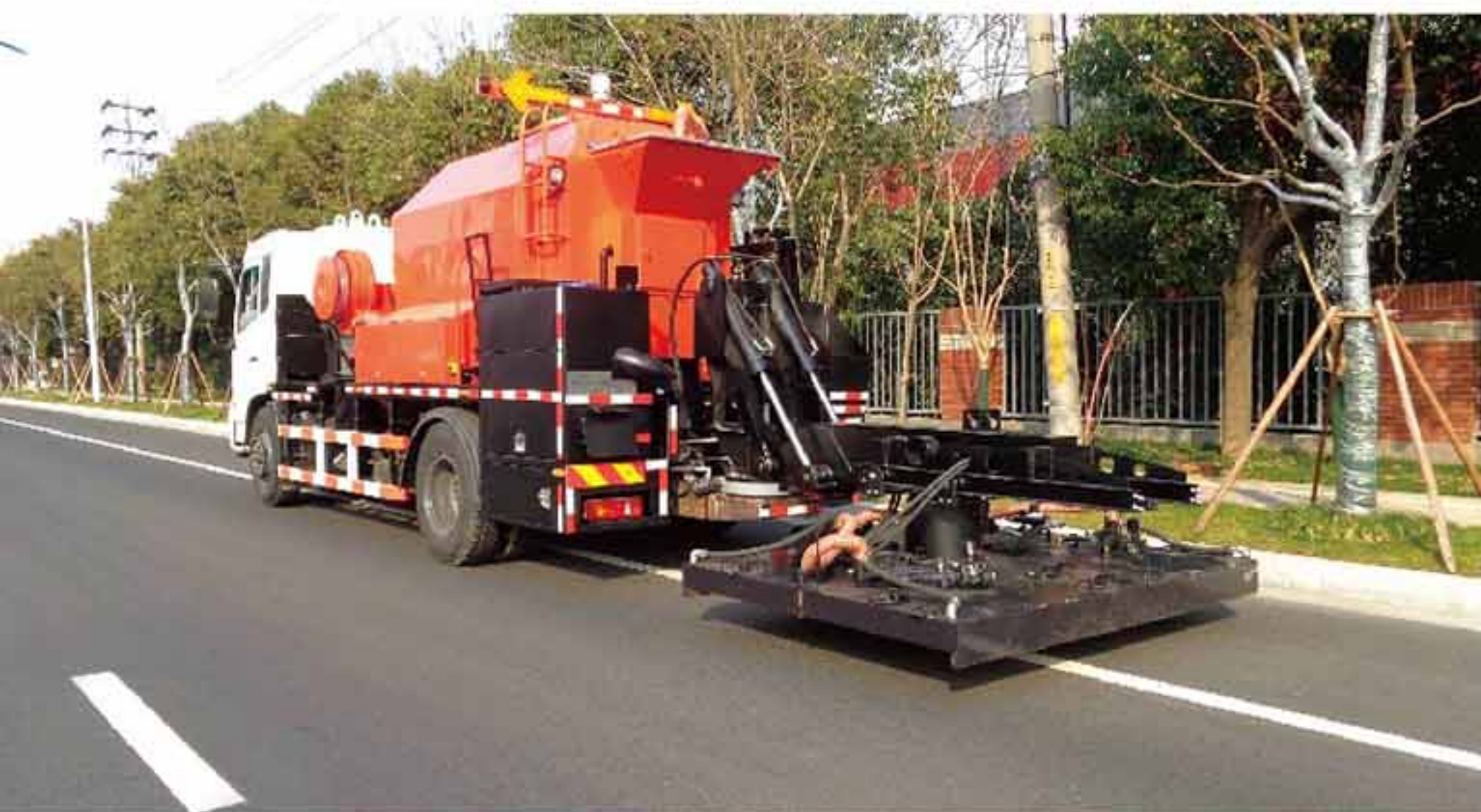
英达间歇式热辐射加热技术确保路面充分软化且不被烧焦
