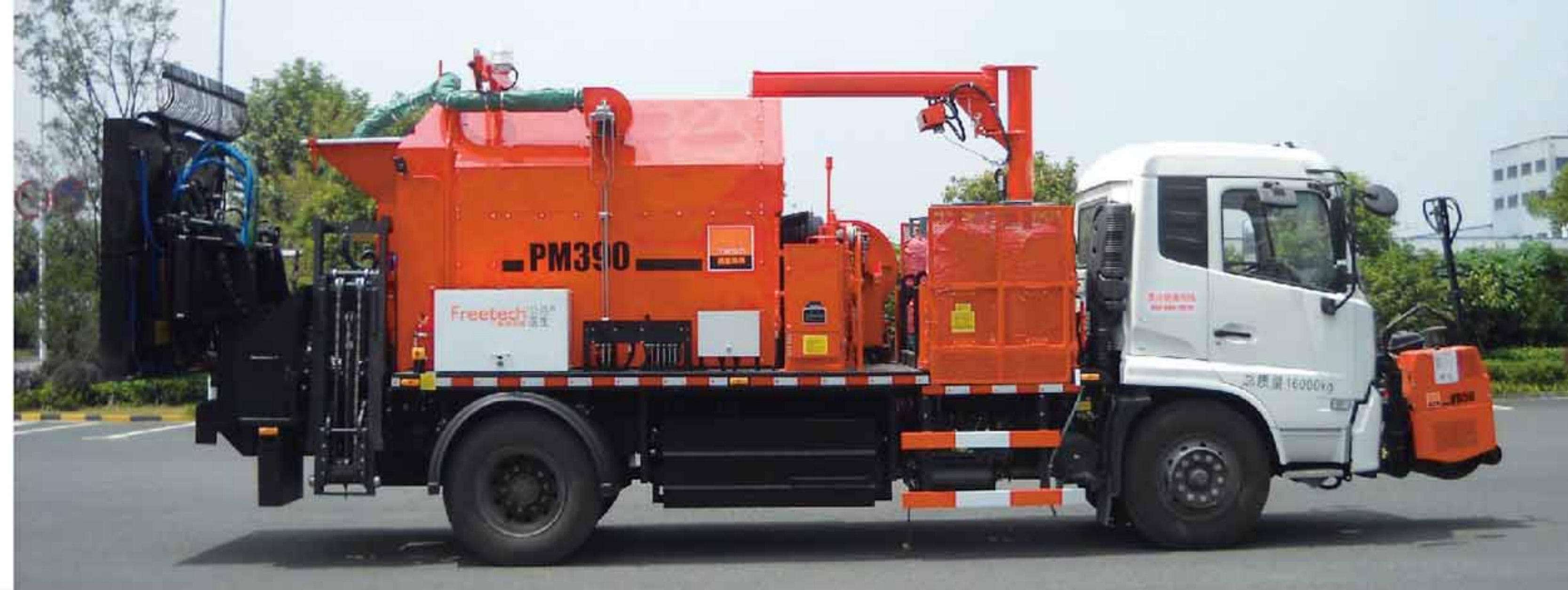
1.8吨旋转料仓确保大面积、长时间、远距离施工供料
