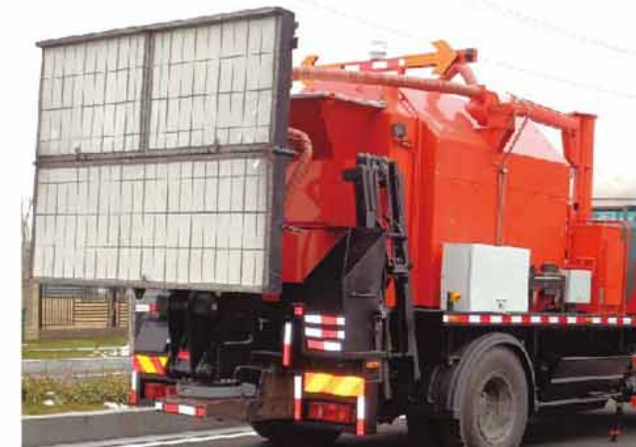
料仓与加热墙同步作业确保供料及时，多段转动控制专利技术精准控制出料质量
