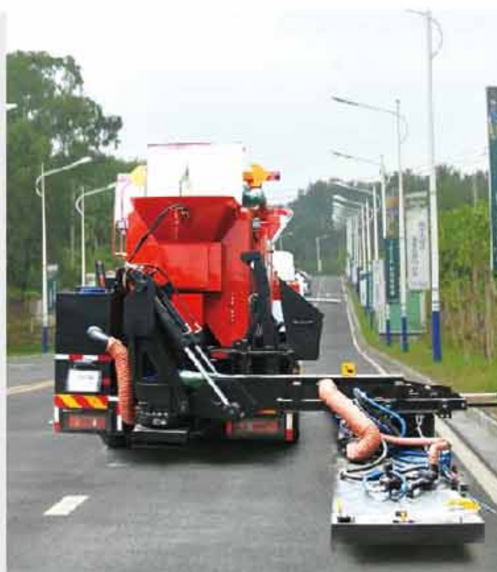
PM390 旋转展开式加热墙可应对裂缝及不规则路病
