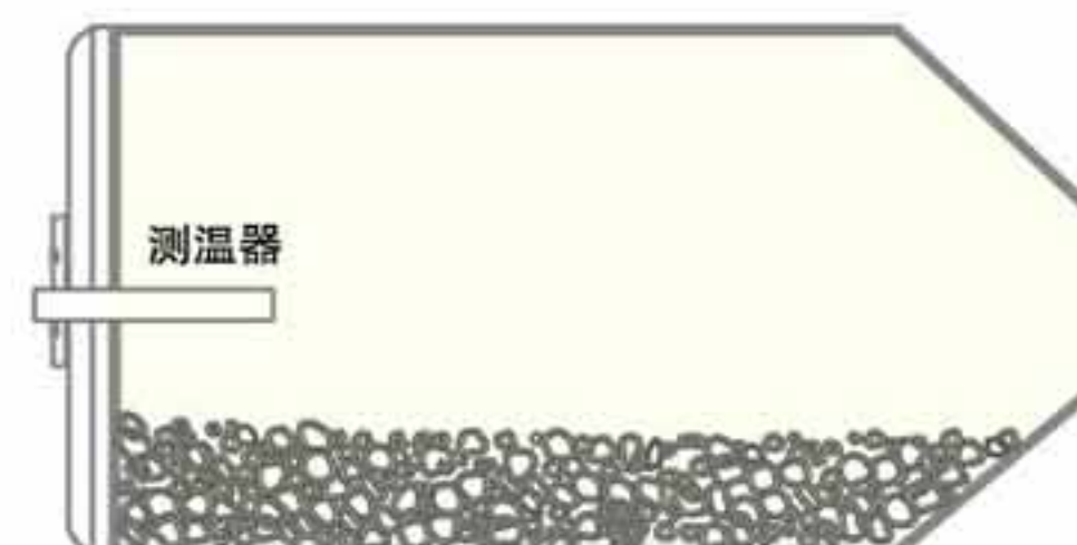
其他厂家测仓内空气温度，间接推算料温，不准确
